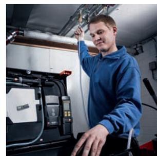
Trink- und Abwasserleitungsprüfung mit Hochdrucksonde bis 25 bar
